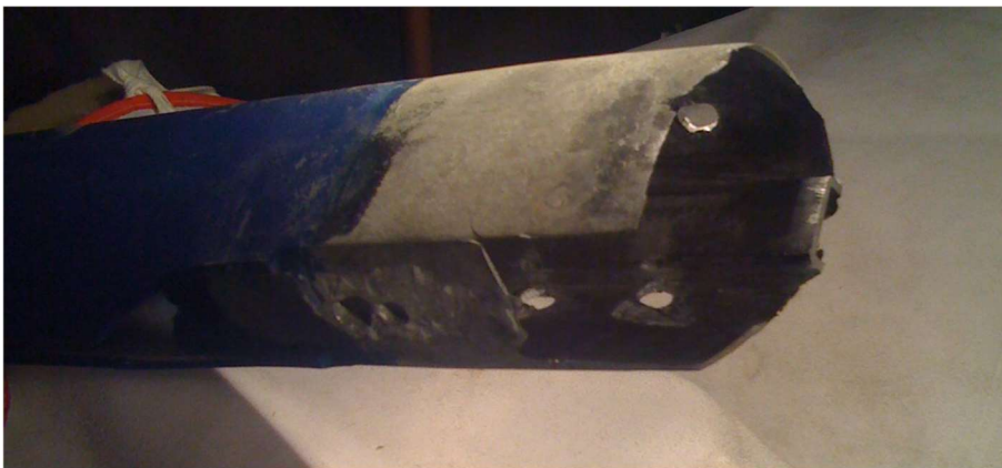
Figure 130. Traverse en aluminium usée
